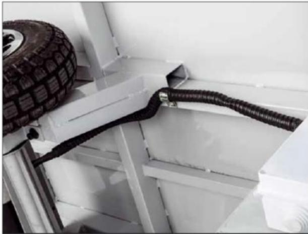
Der stabile Unterbau der Plattform besteht aus Vierkantröhr. Die Achsaufnahme ist besonders stabil gefertigt
