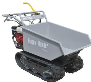
Raupen-Dumper Typ RC 550 Honda GX160 (5,5PS) hydr. Auskippung max. Zuladung 550kg
