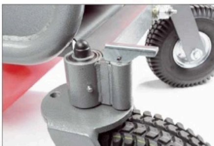
Die Hinterachse ist als Pendelachse konstruiert. Alle Gelenke sind in gekapselten Lagern geführt, die über Schmiernippel nachgefettet werden können
