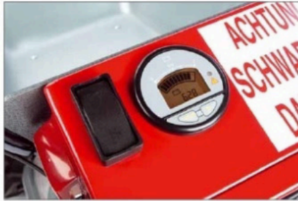
Zwischen den Griffholmen sitzt die Elektrikbox. Das runde Display zeigt den Ladestand und die zu erwartende Rest-Arbeitszeit an. Mit dem Schalter lässt sich die Mulde elektrisch kippen (Sonderausstattung). Zum Laden muss nur das fest angebaute Netzkabel eingesteckt werden
