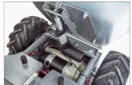
Sowohl der Linearmotor der Kippmechanik als auch der riesige Antriebsmotor mit Differenzialgetriebe hinterlassen einen sehr soliden Eindruck
