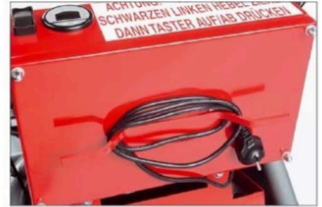
Zwischen den Griffholmen sitzt die Elektrikbox. Das runde Display zeigt den Ladestand und die zu erwartende Rest-Arbeitszeit an. Mit dem Schalter lässt sich die Mulde elektrisch kippen (Sonderausstattung). Zum Laden muss nur das fest angebaute Netzkabel eingesteckt werden
